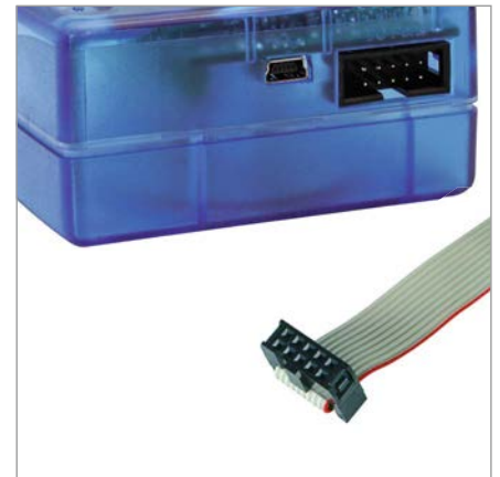
Anschlusskabel für externe Taster (Eingangports) als Zubehör optional erhältlich. Connecting cable for external buttons (input ports) as optional accessory available.
