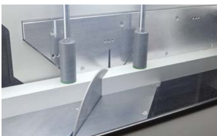
45° und 135° Gehrungsschnitt / 45° and 135° mitre cut
